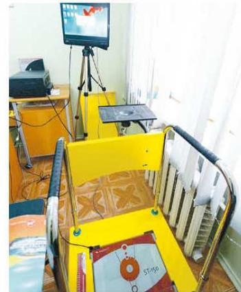
плантации суставов) используется стабилометрическая платформа – прибор для оценки и тренировки равновесия, походки, нагрузки на опорную поверхность в статичном состоянии. При помощи стабилоплатформы пациенты могут улучшить общее физическое состояние и способность к самостоятельному передвижению.
